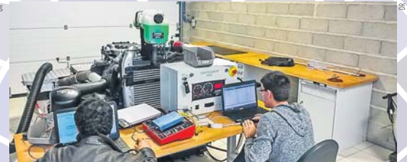
Uma das novidades é um banco de potência, que permite testar motores
