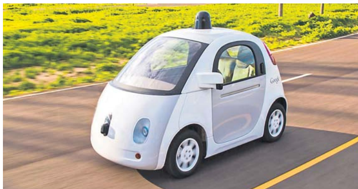
O protótipo lançado pela Google em Dezembro de 2014. O acessório no tejadilho parece um 'pirilampo' como os dos carros da polícia, mas na verdade trata-se de uma parte do sistema de lasers, radares e câmaras que permite ao automóvel deslocar-se sem condutor.
